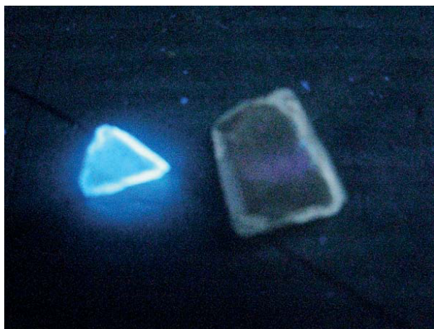
Bild 2: Gegenüberstellung Glassplitter und Referenzglas unter Speziallicht
