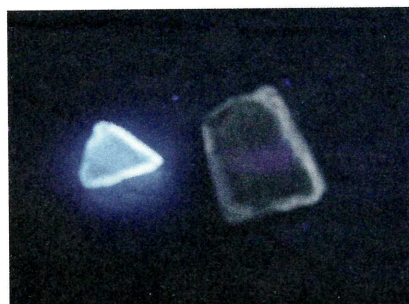
Bild 2: Gegenüberstellung Glassplitter und Referenzglas unter Speziallicht. (Bild: IGR)
