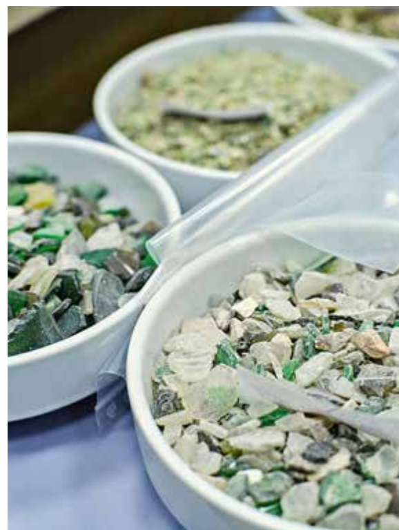
Im IGR werden Scherbenmische untersucht, um zu ermitteln, wie sich die Mischung auf die Weiterverarbeitung zu Recyclingglas auswirkt.
