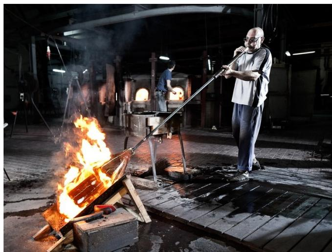
Abb.2 Bild: Produktion mundgeblasenes Fensterglas, © Glashütte Lamberts Waldsassen
