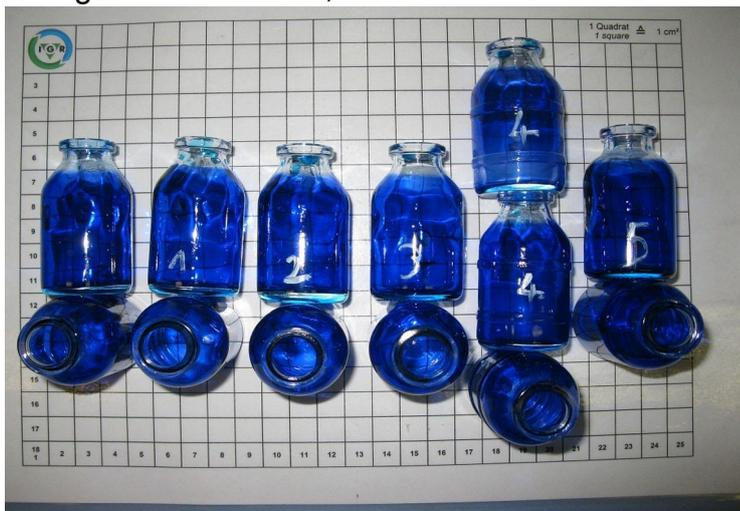
Abb. 1: Typ III-Flaschen mit durch Methylblau visualisierbarer Korrosion
