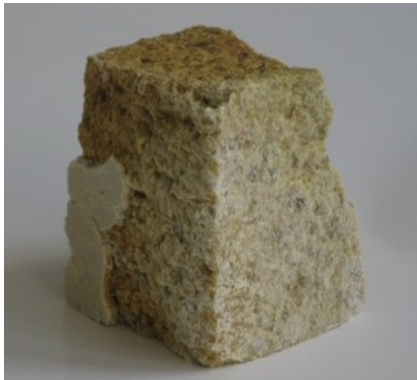
Auskleidung aus einer Regenerativkammer
