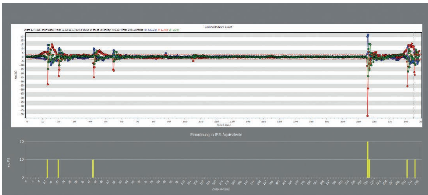
250 ms Ausschnitt einer Messkurve mit daraus resultierender Belastung in IPS
